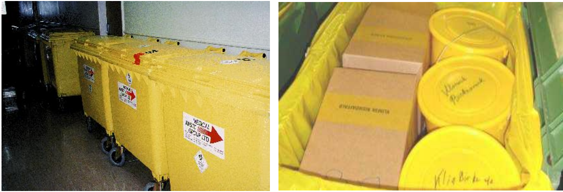
Εικόνες 8 & 9. Τροχήλατοι κάδοι για την ενδονοσοκομειακή μεταφορά μολυσματικών αποβλήτων
